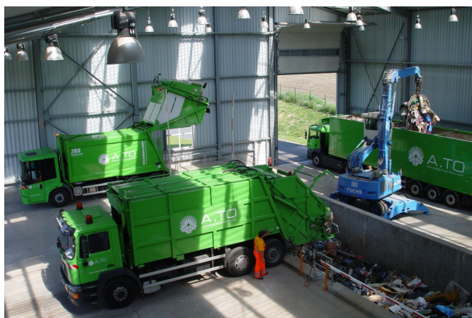
Abfallsammelfahrzeuge entleeren ihre Ladung (6–10 t) in den Bunker der Abfallumladestation auf dem Betriebshof Rechau-Zöschau
