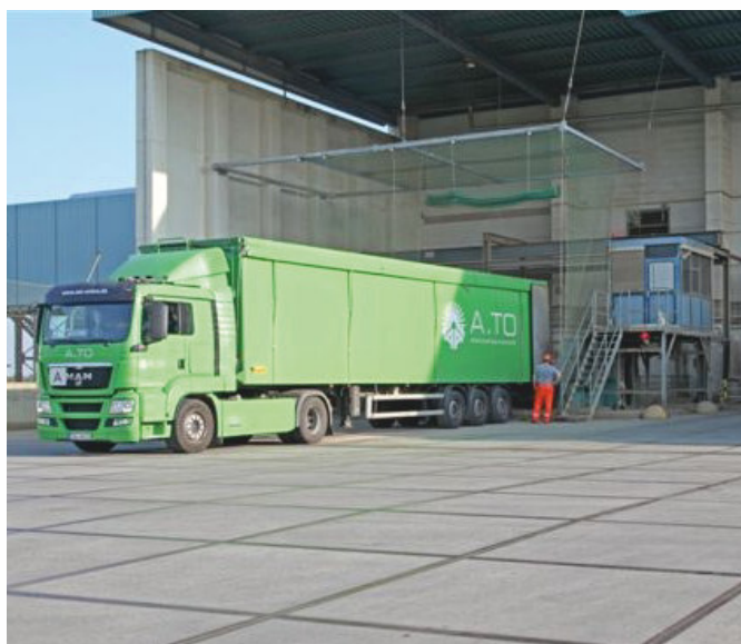
Schubbodenfahrzeug bei der Entladung in der Thermischen Abfallbehandlungsanlage Lauta
